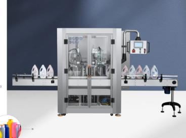
本机为全自动旋盖机,由输盖系统、旋盖系统、夹瓶系统和旋 盖等完成自动旋盖。
