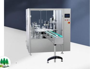
香水灌装锁盖机集光、机、电、气为一体。 该机具有螺杆自动进瓶,瓶自动检测(有瓶灌装,无瓶不灌装,有 瓶落外盖, 无瓶不落外盖), 自动灌装, 自动落外盖, 自动压盖等 功能。
