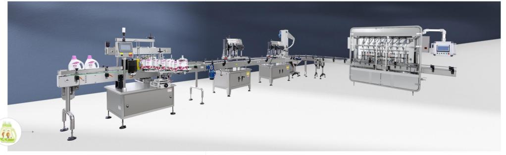
该机自动化程度高,调节方便,当改变规格或修正计量时只需 在显示屏上调整即可满足所需精确计量。可适用于植物油、蜂 霉、果酱、糖浆、制剂、悬浮剂、机油和日化行业各种粘稠物 料的灌菇。
